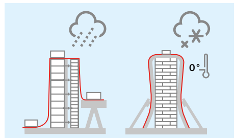
Bild 11 Frisches KS-Mauerwerk ist vor Regen und Frost zu schützen.
